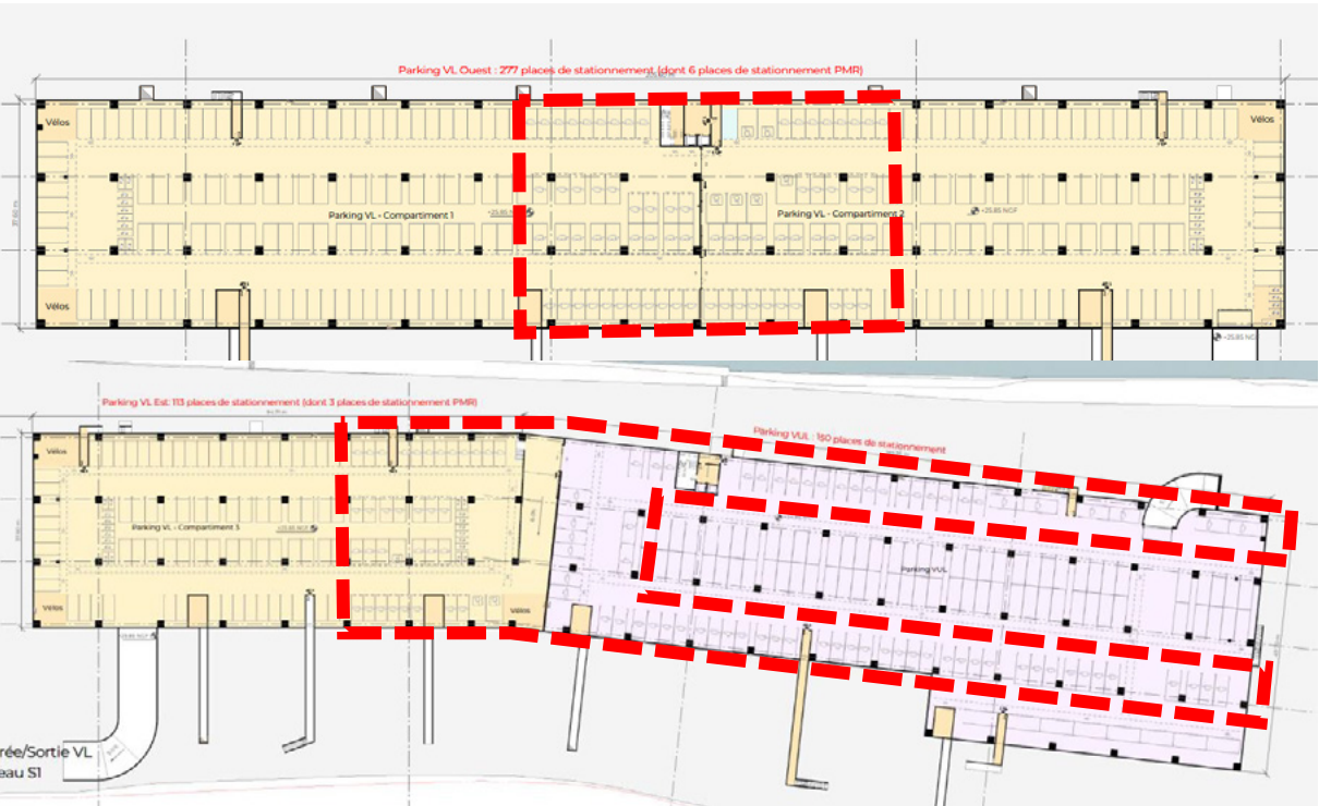
Figure 38 : Localisation des zones de recharge des véhicules électriques en sous-sol (Source : A26)
