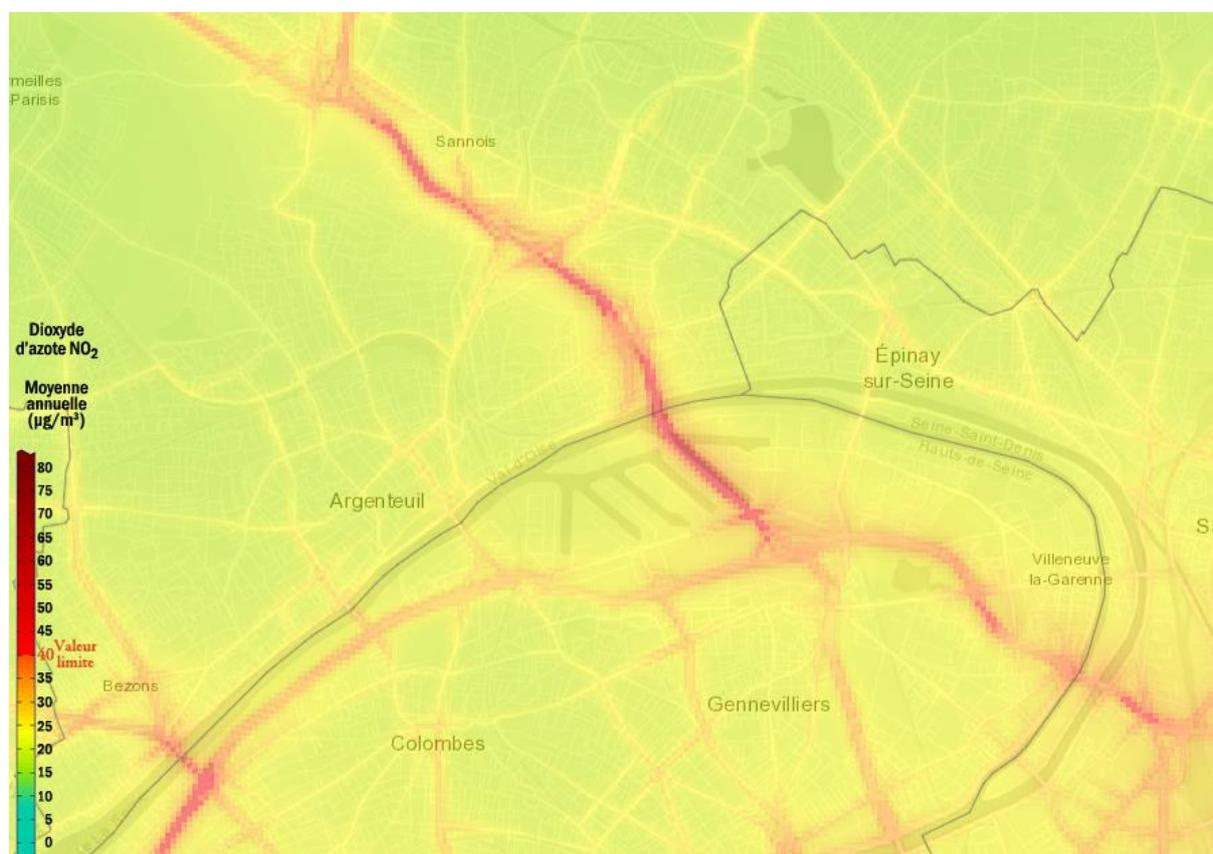
Figure 14 Concentration moyenne annuelle modélisée en NO<sub>2</sub> (Source : Air Parif)
