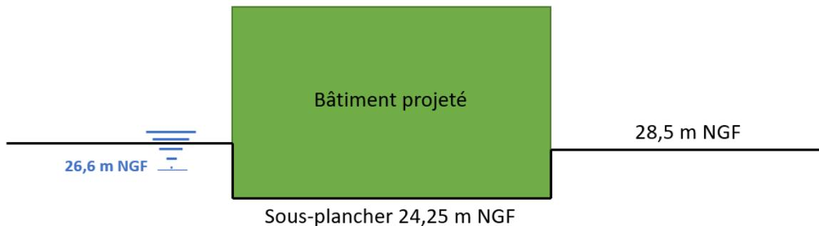
Les sous-pressions sous le plancher sont de :  $(26,6 - 24,45) \times 10 = 23,5$  kPa
