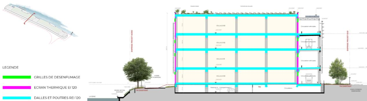
Figure 8 : Vue en coupe transversale – Tenue au feu des planchers et façades
