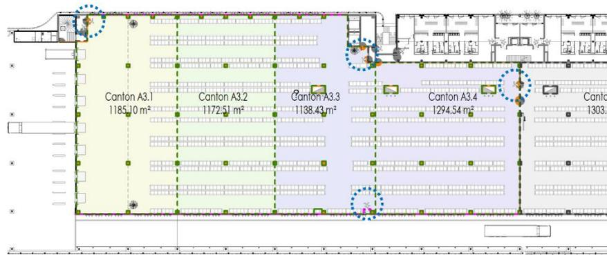
Figure 10. Repérage des sorties/issues de secours du bloc A
