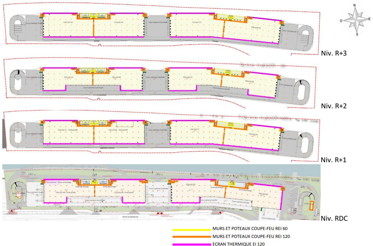
Figure 4. Vues en plan des niveaux RDC à R+3 – Tenue au feu des parois et façades
