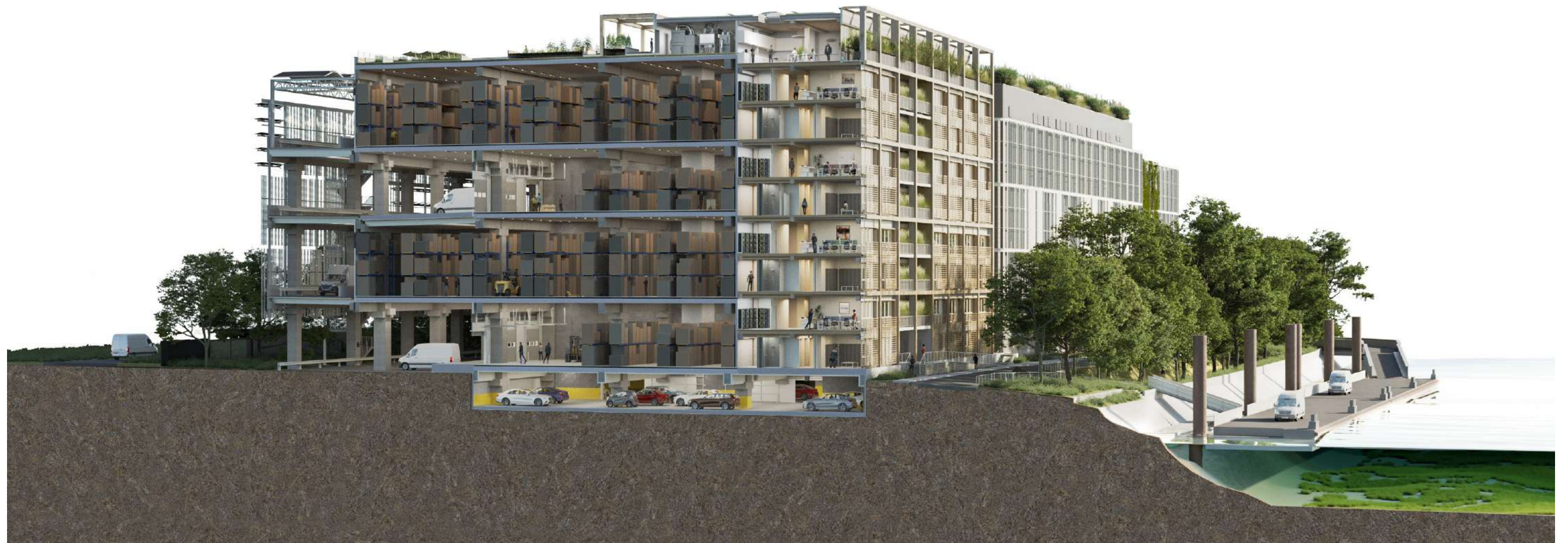
Figure 30 : Coupe perspective bloc AB - cellules logistiques et bureaux
