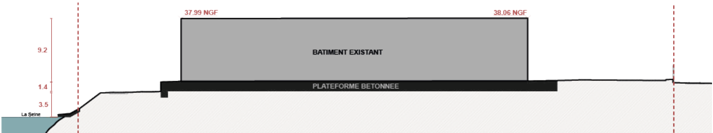
Figure 12 : Coupe schématique AA (voir repérage figure 7) - Terrain avant démolition
