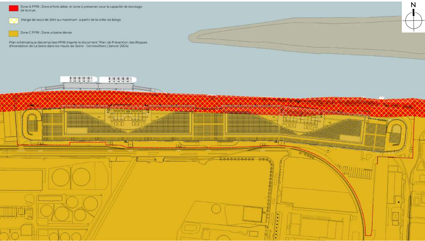
Figure 51 : Plan de masse du projet avec emprise du PPRI
