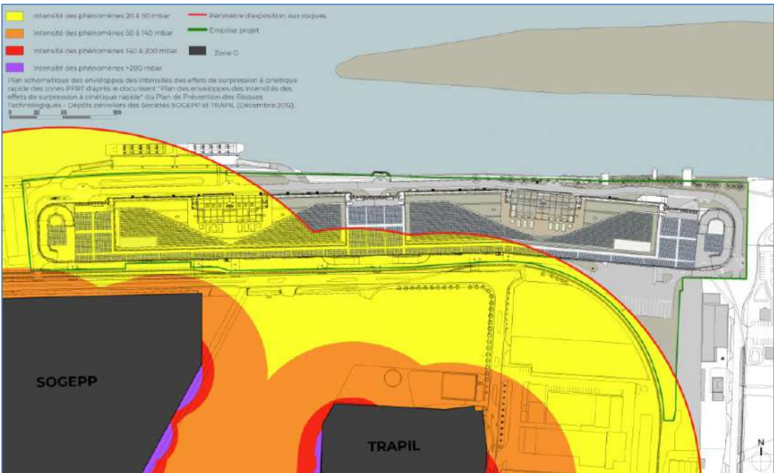
Figure 4 : Courbes d'enveloppes des effets de surpression (Source : A26)
