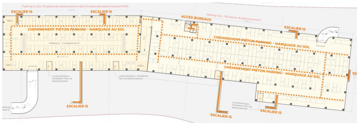
Circulation piétonne sous-sol aile Est
