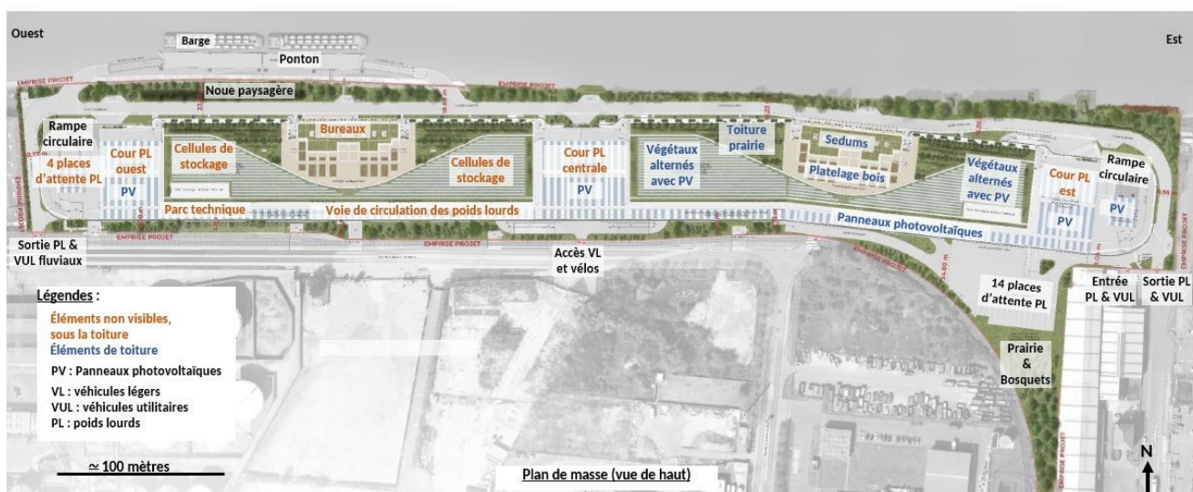
Illustration 11- Façade nord du projet - (p. 91, modifié par la MRAe) et plan de masse du futur projet montrant la toiture végétalisée (p. 65, légendes ajoutées par la MRAe, car non lisibles en A4). Sedum est un genre de plantes succulentes.
